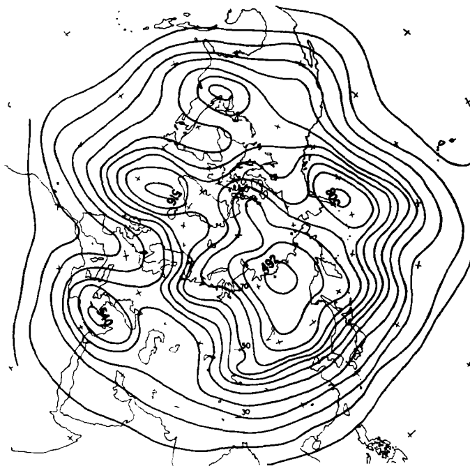
图3 1958年1月27日00点(世界时)24小时500毫巴预报图 (预报模式为正压地转方程)
